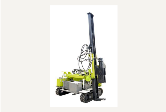
Bariyer Kazık Çakma Makinası
